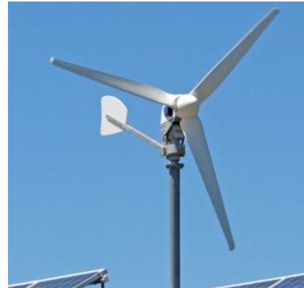
Slika: Primer vetrne elektrarne 3,5 kW za samooskrbo
